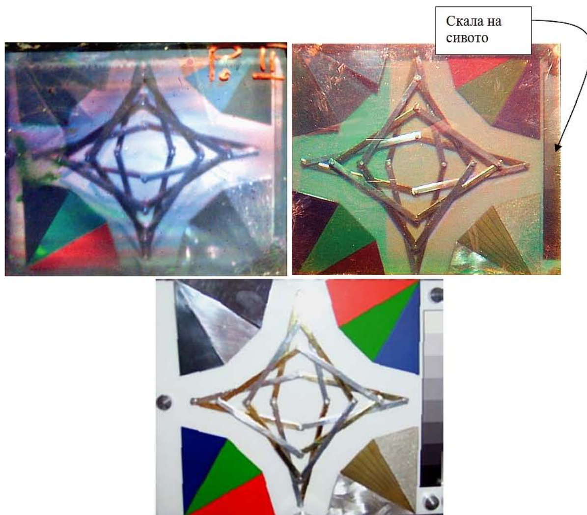
Фиг. 3.14 Възстановено изображение на тестов обект от еднослойна (отляво горе) и двуслойна (отдясно горе) отражателни холограми, записани върху свръхдребнозърнест светлочувствителен материал. Цветен холографски еталонен обект (долу център)
