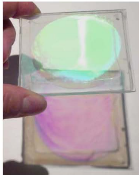
Фиг. 2.18 Селективно холографско огледало записано на БХЖ плака. Характерно свойство за ХОЕ огледалото е много тясната работна спектрална ивица, което същевременно осигурява минимални загуби в пропуснатия спектър
