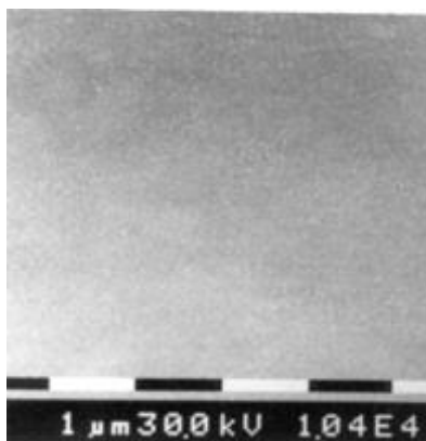
Фиг.12. SEM микрофотография на PI слоеве, получени при прилагане на EAD при : U_a = 4,5 \text{ kV} и U_k = 12 \text{ V} .
