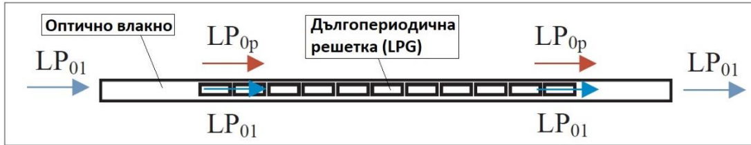
Фигура 2.10. Дългопериодична решетка, в която основната мода в сърцевината LP_{01} и модата от по-висок порядък в обвивката LP_{0p} обменят мощност.
